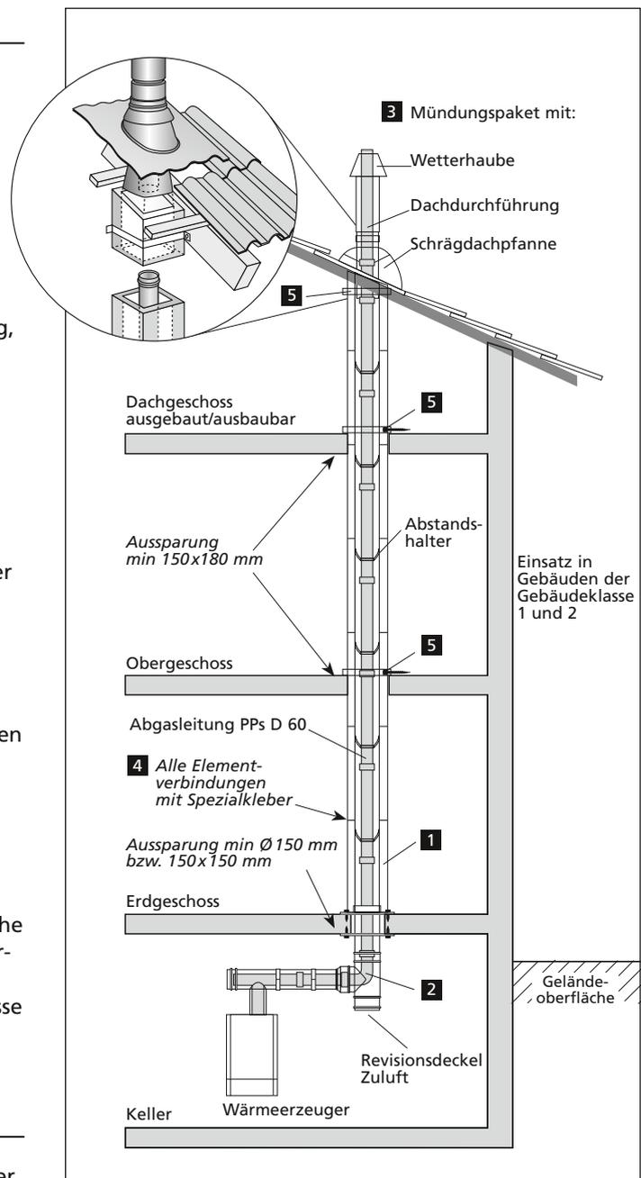
SKOBIFIX<sup>®</sup> nano 30 – System-Leichtbauschacht L<sub>A</sub>30 inkl. Abgasleitung D 60 für Brennwerttechnik, Außenmaß 130 x 160 mm, zum Einsatz in Einfamilienhäusern
